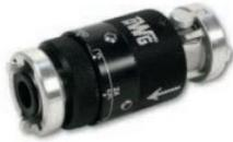
für Netzmittelzumischung für alle handelsüblichen Zumischer Z2 und Z4; Anschluss an den Saugeingang des Zumischer, Rückschlagventil integriert; Einstellbare Zumischraten 0,1%, 0,5% und 1,0%;
