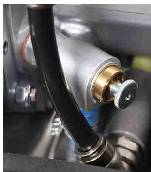
Mechanisches Thermostatventil mit Spülfunktion serienmäßig
