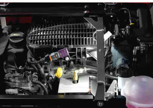
Wassergekühlter Ottomotor, leiser und vibrationsarmer Motorlauf, niedrige Abgastemperaturen und beleuchteter Wartungszugang
