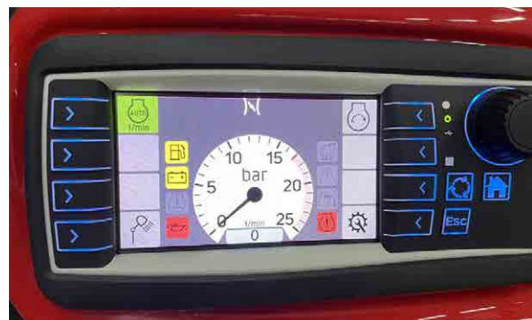
Selbstleuchtendes Farbdisplay mit Drehregler für Drehzahlverstellung und Pumpendruckregelung sowie QR-Code zur Online-Bedienungsanleitung
