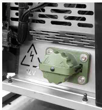
NATO-Fremdstartsteckdose 12 V DC und OBD II Diagnosestecker
